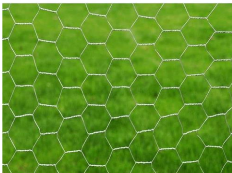
Grillage en métal galvanisé servant à clôturer
